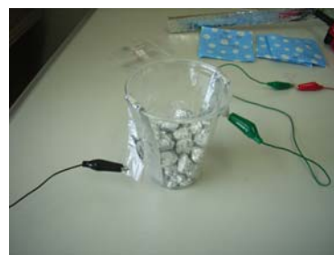
図 5. コヒーラの製作 アルミホイルを約 10 cm 四方に切り、これを丸めて直径 7 mm ほどの玉を複数作る。玉をカップの半分くらいまで入れる。
