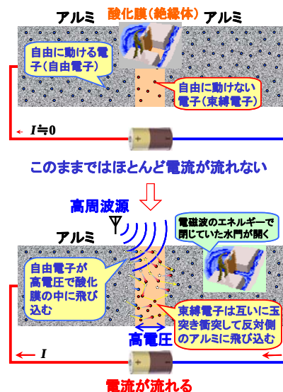
図1. コヒーラの原理
