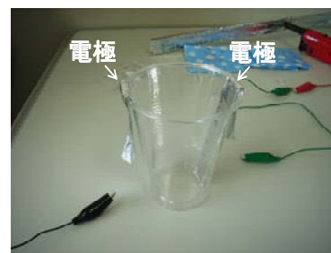
図 4. 電極の製作 2 アルミ帯の方端がカップの底につくように入れ、2 本を向かい合わせにして電極にする。
